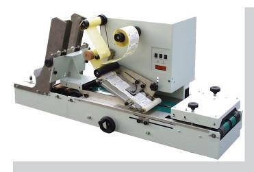
Conçue par JMV Robotique, l'étiqueteuse LAB510 permet de déposer automatiquement une étiquette adhésive sur un produit de surface plane de type CD, DVD, pochettes, cartes, boîtiers, cartonnages,
